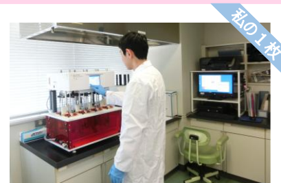
溶出試験器を用いて、後発医薬品の品質検査を行っています。
