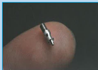
(有)大堀研磨工業所 ロケットに搭載する部品 の研削加工
