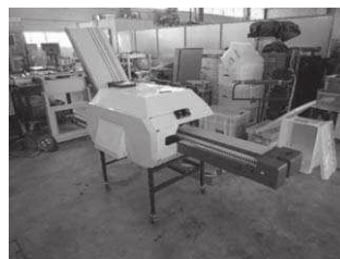
【写真2】 ハウレンソウの高効率調整機の開発〔中山間農業研究所〕
