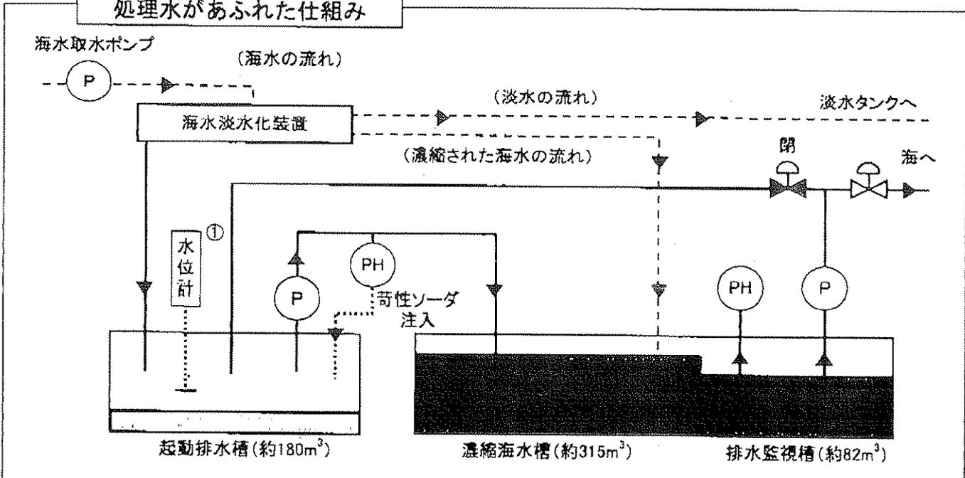
①起動排水槽の水位計の不調により、従来とは逆の濃縮海水槽から起動排水槽へ水を送るなどして、点検を行っていました。
