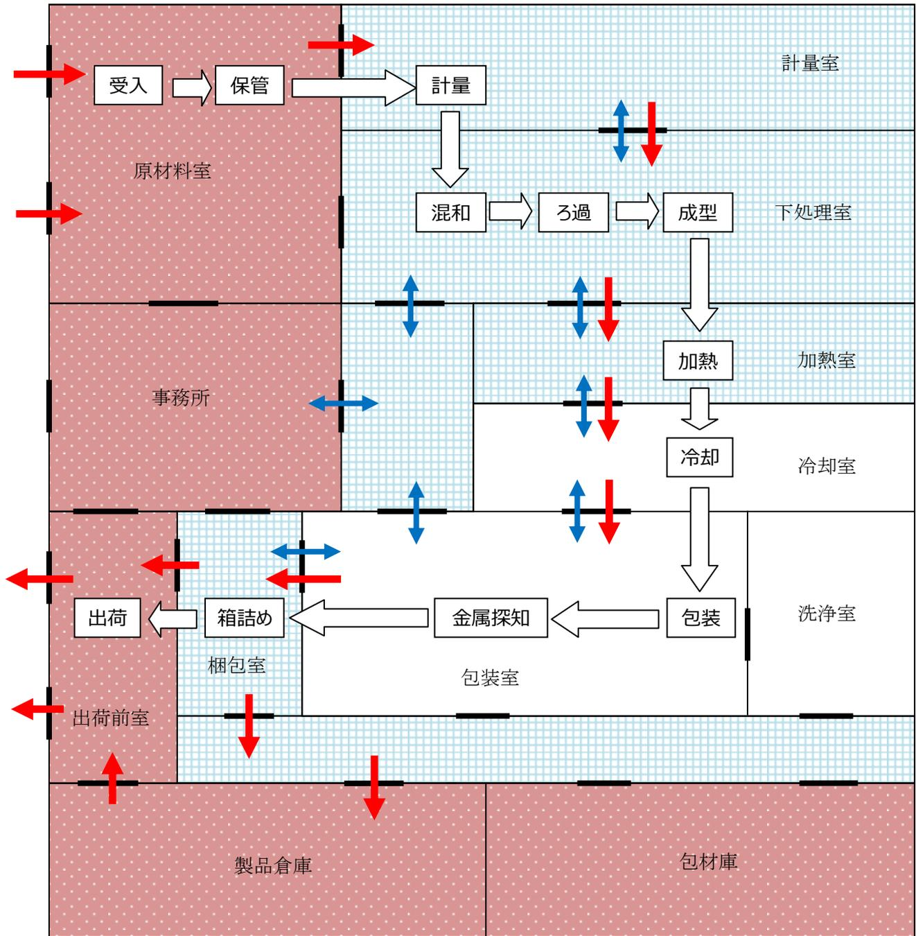
○原材料受入から出荷まで、全ての工程の施設平面図を作成する。
