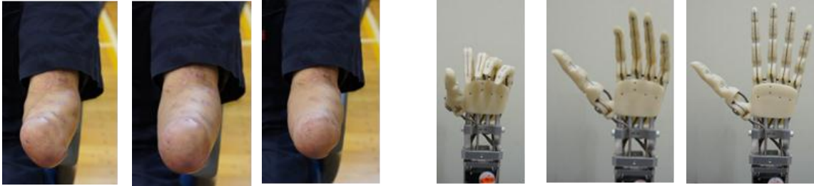
図1 前腕の回転運動による皮膚変形の様子 (左：回内状態、中央：中立状態、右：回外状態)
