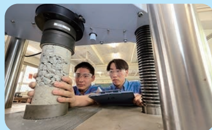
コンクリートの強度試験
