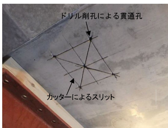
写真 2 漏水検知試験用スリットの作製状況
