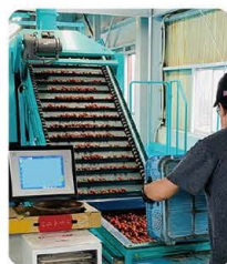
選果機 コンテナからホッパーにあけた ミニトマトが傾斜コンベアで 上がっていく様子
