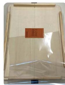
シール貼り用治具の例
