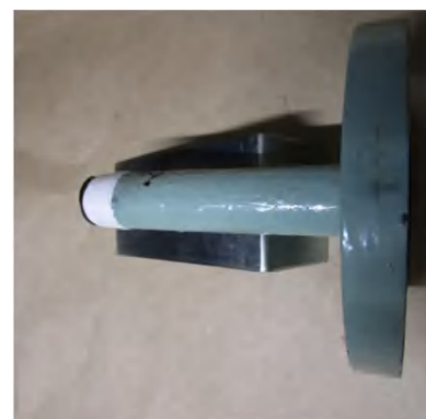
シールテープ巻き直し後
