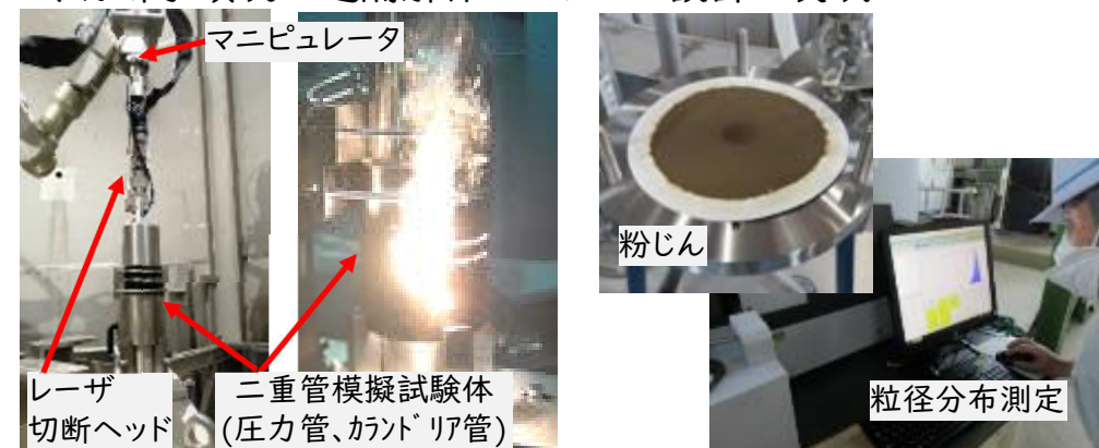
原子炉水中解体モックアップ試験
