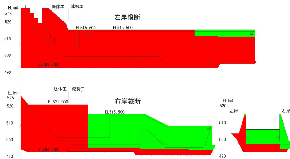
コンクリート打設進捗状況 (R8.4末時点)
