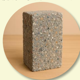
廃材を使用したブロック
