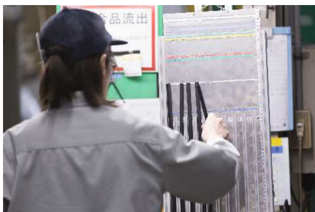
作業員の身長に合わせて 高さが変更できる検査板
