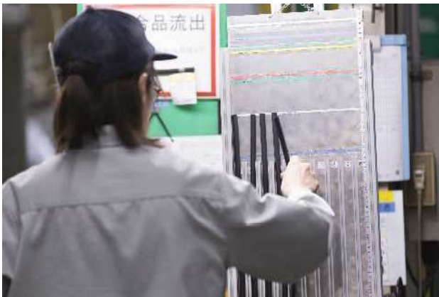
作業員の身長に合わせて 高さを変更できる検査板
