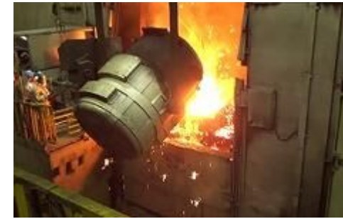
⑦ 鋳枠に溶かした鉄を 流し込む
