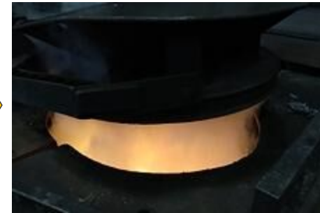
④ 1,400～1,450度に 加熱して溶かす
