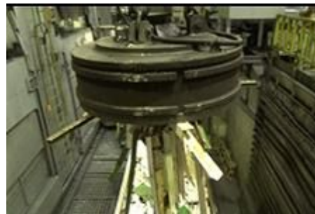
③ マグネットで吊り 上げ溶解炉へ
