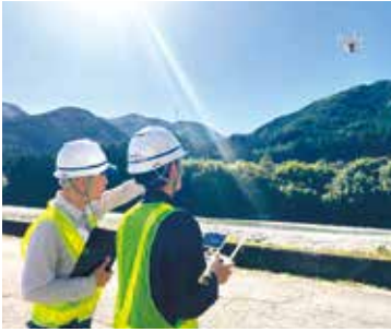
ドローンによる空中撮影測量導入で作業時間を大幅に短縮。
