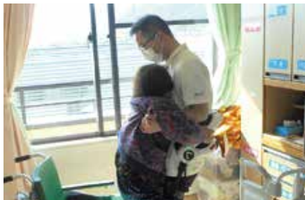
腰装着型の介護支援ロボットHALを3台導入。抱え上げる際に動作がアシストされるため大きな力が要らず、腰への負担が大幅に減少した。
