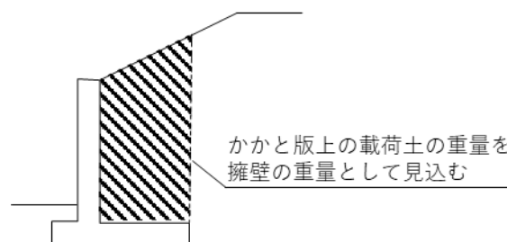
図 2-10 擁壁の自重の考え方(例)
