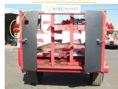
後部反射器及び灯火器類の設置例
