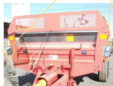
後部反射器及び灯火器類の設置例
