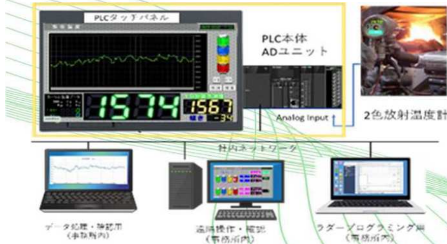
出湯温度連続測定システム
