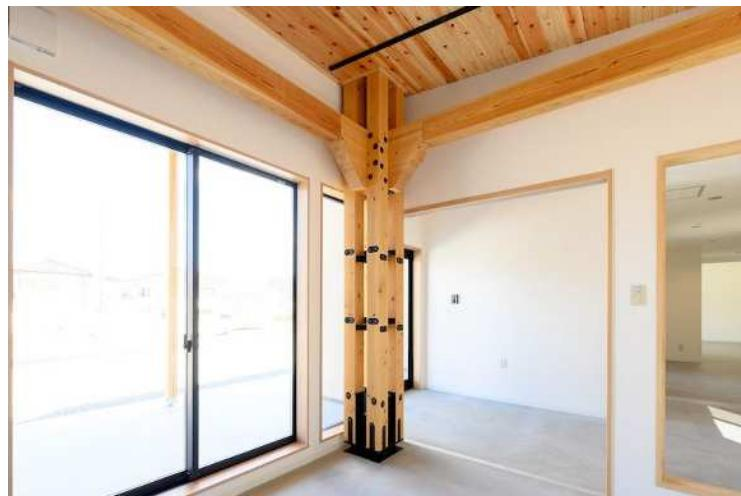
室内から作業場へと連続して伸びる梁と、構造体として採用された囲柱ラーメン木構造により、空間全体に木の存在感が広がっている施設となっています。
