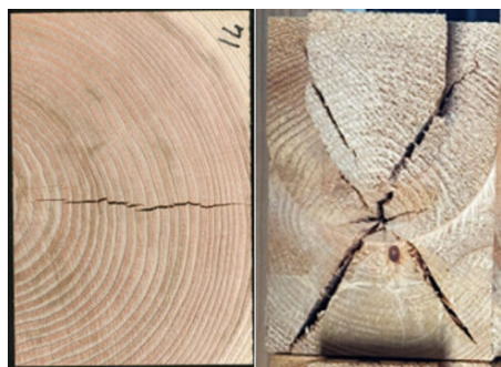
写真1 内部割れ発生の様子 左：心去り材 右：心持ち材
