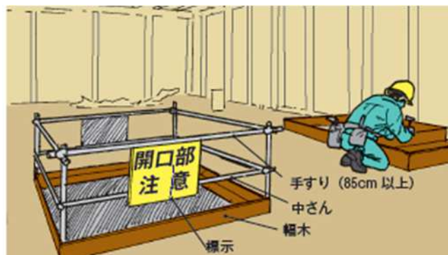
開口部周りの墜落防止措置の例
