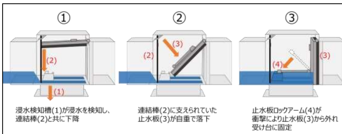
浸水防止ダンパの作動イメージ
