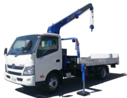
小型移動式クレーン
