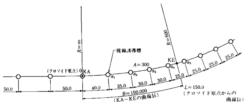
図 9.100 クロソイド区間における視線誘導標の設置例（単位：m）
