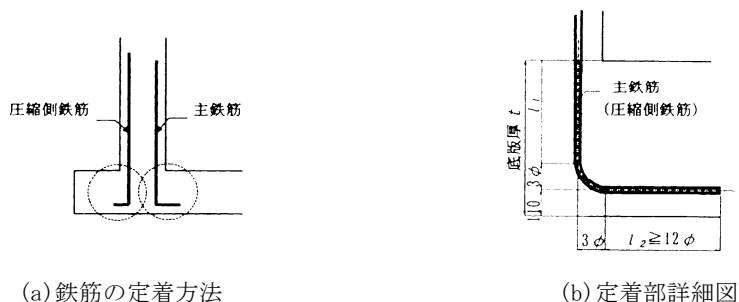
図4.2.32 たて壁鉄筋の定着方法
