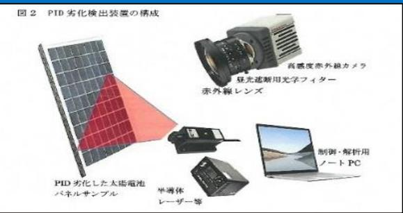
図2 PID劣化検出装置の構成
