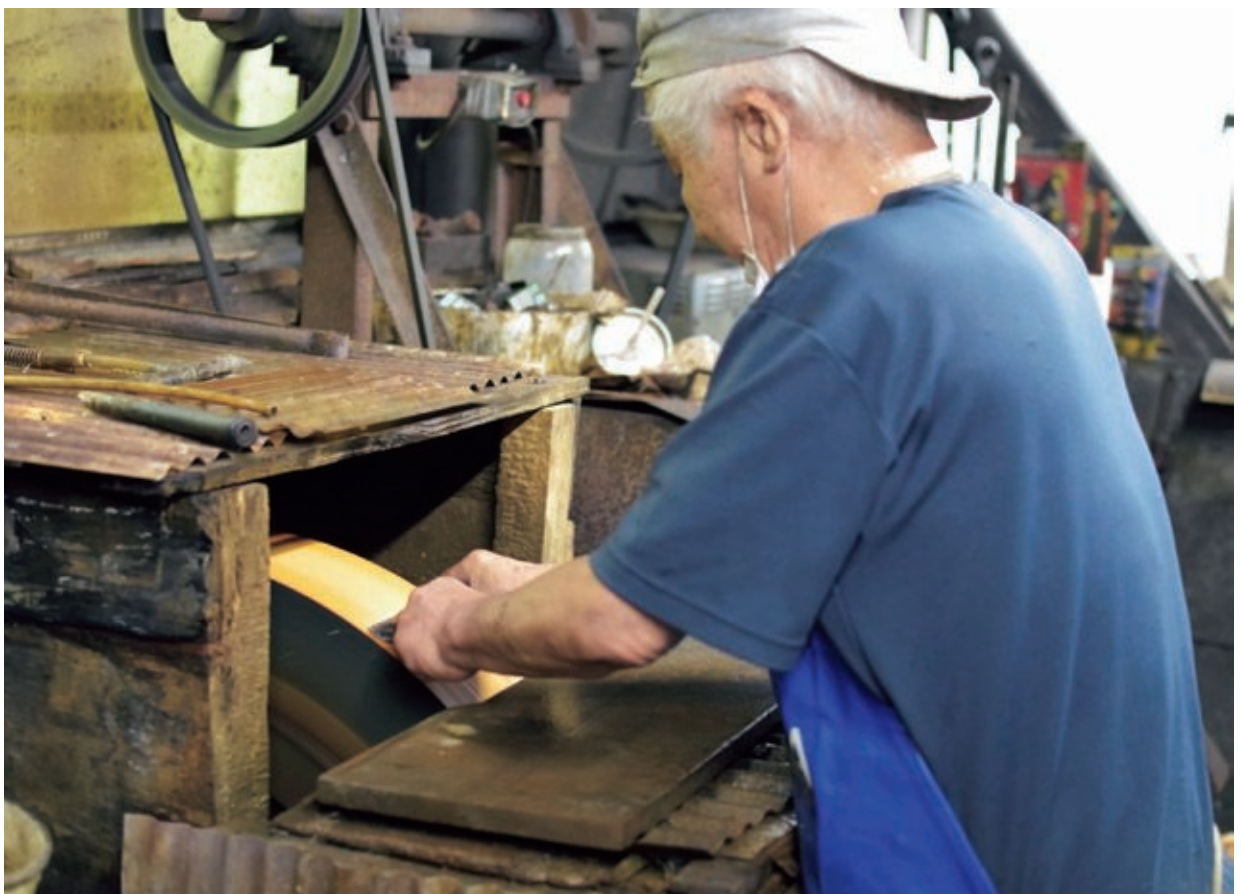
内丸鉋などの丸刃や特殊な形状の刃は専用の砥石と熟練した技術を要するが、対応可能な研磨職人は限られている。 新潟県長岡市の研磨職人・坂口研屋の坂口 文夫 氏の作業の様子
