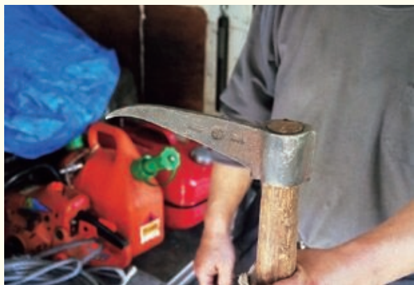
江崎 氏所有のトビ。 既製品に天鋼をつけてクサビを打てる機能を持たせている。
