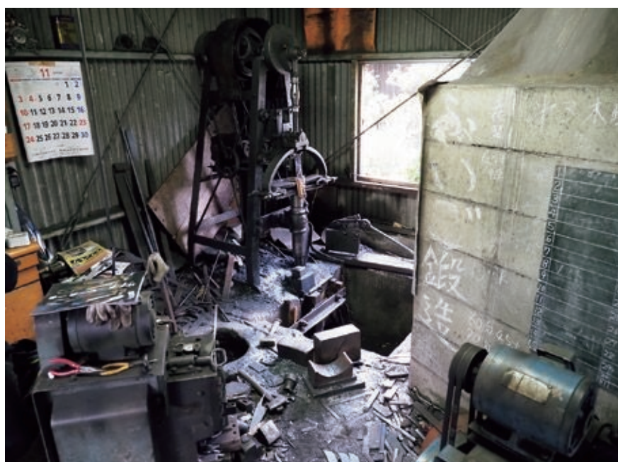
鎌を生産する山崎 洋介 氏の鍛冶場。鎌などの薄物と鉋などの厚物では、ベルトハンマーのサイズが異なるため、個人の鍛冶屋はいずれかに特化する。
