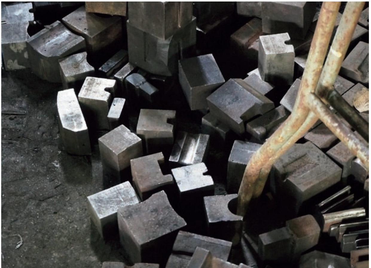
鑿の製造には刃物のアールに合わせた型を用いる。 兵庫県三木市の鑿鍛冶・小山市刃物製作所
