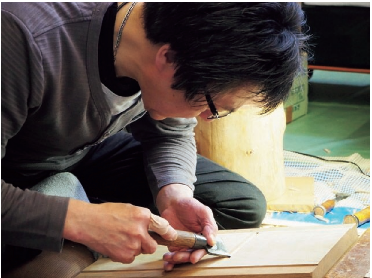
鉋の部品である鉋台を製造する職人にも鑿が必要であり、互いの職人が密接な需要・供給関係を築いている。 新潟県三条市の鉋台職人・小吉屋 渡辺木工所の渡辺 光雄 氏の作業の様子。
