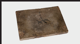
23 棚板(窯道具) 焼成の際、窯内で作品をのせる板。
