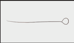
7 ひっかき棒(鉄製) 焼成中の作品の位置や向きを変えるために使う道具。
