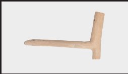
6 ロクロボセ ロクロを回すための棒。
