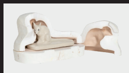
17 石膏型(圧力鑄込み) 陶磁器の原料を圧力を掛けて流し込み、成型するための道具。
