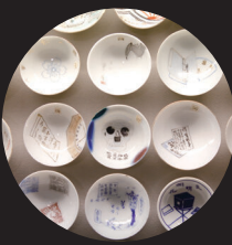
24 桶(瀬戸黒引き出し用) 瀬戸黒制作工程で、窯から引き出した茶碗を急冷して漆黒に呈色させる際に使用する道具。
