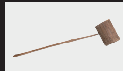
14 ひしゃく 釉薬を作品にかける際に使用する道具。
