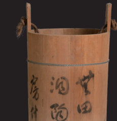
24 桶(瀬戸黒引き出し用) 瀬戸黒制作工程で、窯から引き出した茶碗を急冷して漆黒に呈色させる際に使用する道具。
