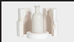
16 石膏型(排泥鑄込み) 陶磁器の原料を流し込み、花瓶や徳利など袋状の製品を作るための道具。
