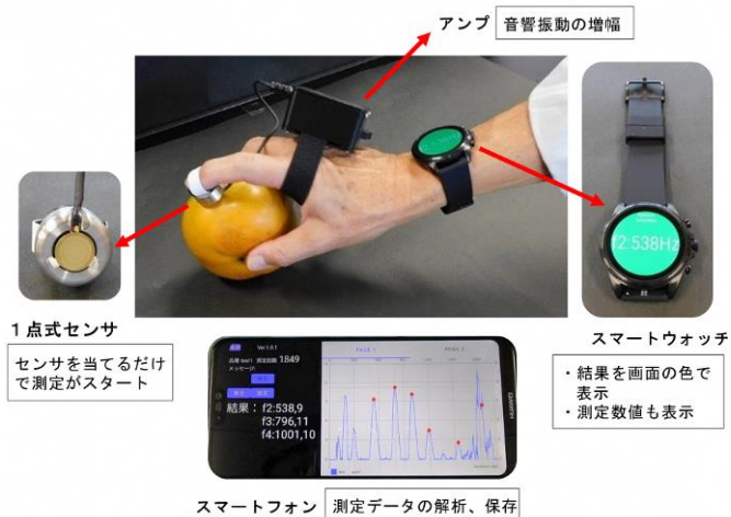
図2 開発した1点式センサの携帯型装置
