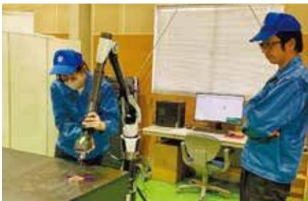
非接触式三次元測定機は、男女問わず未経験の方でも高精度な測定が可能。一人でできるようになるまで上長が付き添い研修を行う。
