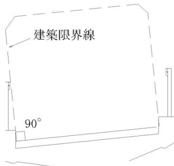
図 3.1.1 防護柵の設置
