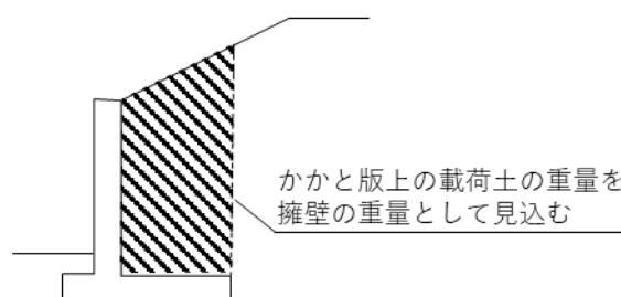
図 2-10 擁壁の自重の考え方(例)
