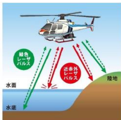
図- 2.8 航空レーザ測深（ALB）の計測イメージ及び河道の三次元計測データ
