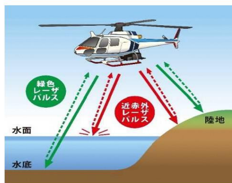
図- 2.8 航空レーザ測深（ALB）の計測イメージ河道の三次元計測データ
