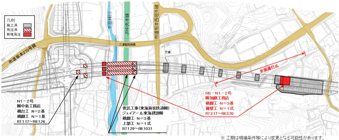
■新規工事は、橋梁下部工3基と擁壁を施工します。
