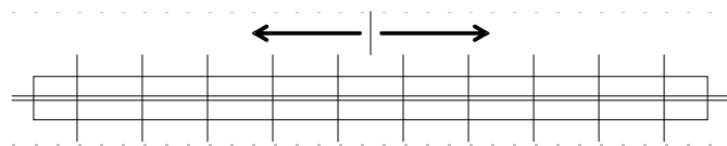
図 1-1 ボルト締付け順序
