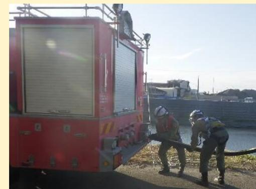
小型動力ポンプ付水槽車へのポンプ接続
