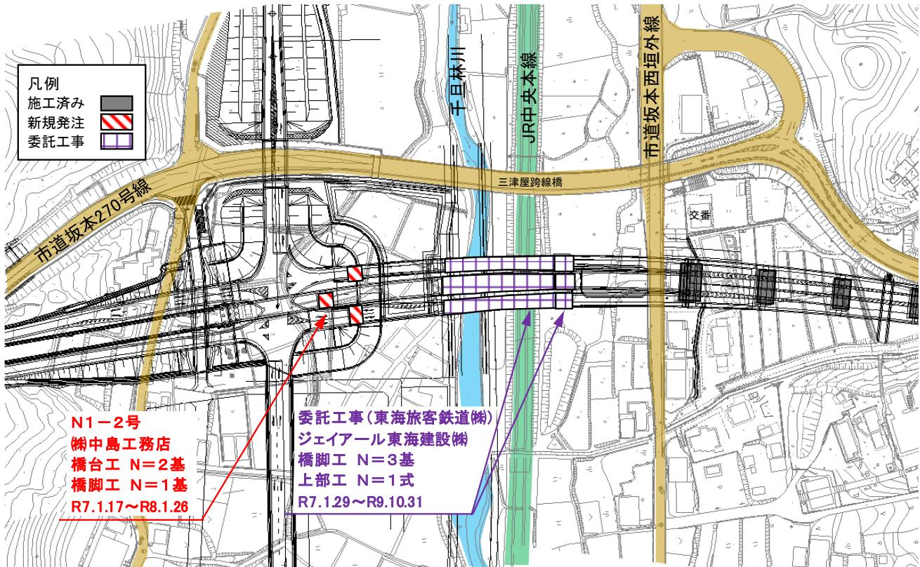
■新規工事は、橋梁下部工を3基施工します。
