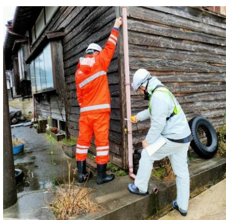
下げ振りで傾きを測定
