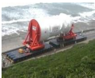
原子炉圧力容器の 陸上輸送の様子
