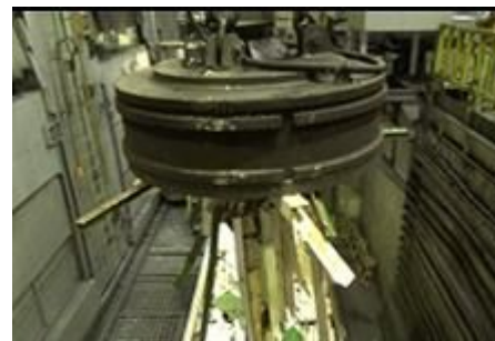
③ マグネットで吊り 上げ溶解炉へ
