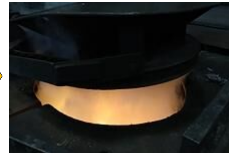
④ 1400～1450度に 加熱して溶かす
