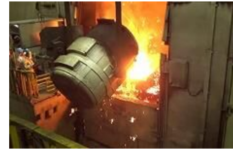
⑦ 鋳枠に溶かした鉄 (溶湯) を流し込む
