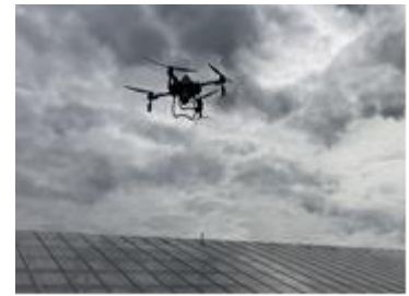
【ドローンによる塗布剤散布】
