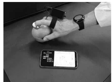
柿の食感を測定するウェアラブル型装置
