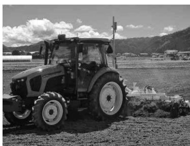
ロボットトラクタによる整地作業（飛騨市）
