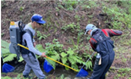
① 渓流用背負い式電気ショッカー 最低2名で作業可能
