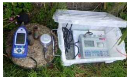
騒音計・振動計設置状況
