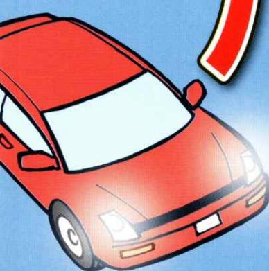
例えば時速60kmで走行中、運転者が前方の危険に気づいてブレーキペダルを踏み、ブレーキが効き始めるまでに1秒かかるとすると、この間に進む距離は約17m、ブレーキが効き始めて車が停止するまでに要する距離が約27mですから、合わせて約44m必要です。
