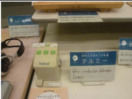
音声コード読み取り機です。広報物などに添付されている活字情報を記録した音声コードを読み取り、音声で読み上げる装置です
