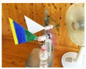
ペットボトルで作った風車で、LEDランプを点灯します。
